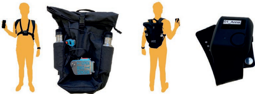
Abbildung 6: Schematische Darstellung des Sensorequipment mit Smartphone, Empatica E4, GoPro-Kamera sowie zum Open-WalkSensor umgebauten OpenBikeSensor.
