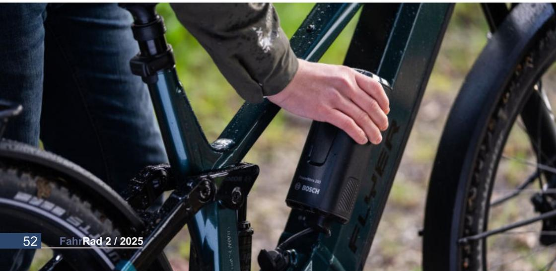
mechanisch beschädigt werden. Wird eine Zelle deformiert, kann es zu Kurzschlüssen und starker Hitzeentwicklung kommen. Im Brandfall kann eine Kettenreaktion entstehen, bei der mehrere Zellen nacheinander explodieren. Nach einem Sturz sollte das Fahrrad daher nicht nur auf Lackschäden, sondern auch auf sichtbare Schäden an der Akku-Außenhaut geprüft werden. Nicht sichtbare innere Schäden erkennt man oft nur durch eine ungewöhnliche Wärmeentwicklung am Akku.
